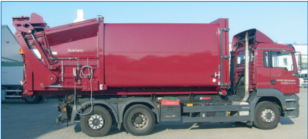
Hecklader mit Schüttung für 5 cbm, 1100 l und 240 l MGB
