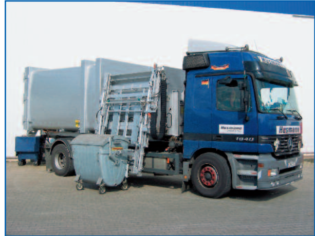
Selbstpressender Behälter mit Seitenlader für 1,1 cbm-Behälter
