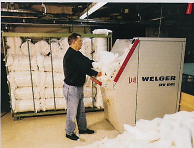
Der RV 642 ist ebenfalls für die Verarbeitung von Folien und ähnlichem Material entwickelt worden. In seinem Bedienpult ist die komplette Ablaufsteuerung integriert. Nur der Folieneinwurf erfolgt manuell. Die weiteren Schritte laufen automatisch ab: Umwickeln des Ballens, Abtrennen der Bindefolie, Öffnen der Ballenkammer, Auswerfen des Ballens und Schließen der Ballenauswurfklappe.
