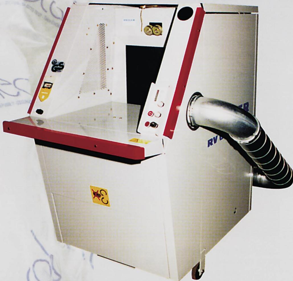
In einer speziellen Ausbaustufe wird der Welger Rollverdichter auch in vielen Bereichen der Chemischen Industrie eingesetzt. Die hier anfallenden Materialien sind mit Reststäuben belastet und kontaminiert. Durch eine ständige Absaugung in den staubintensiven Zonen des Materialeinzuges wird der Staubanteil reduziert, der in die umgebende Atmosphäre gelangt.
