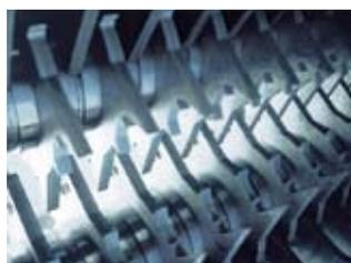
Robuste Walzen aus spezial gehärtetem Stahl.
