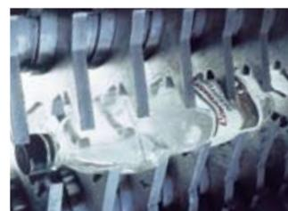
Spezielle Walzenform mit großen und kleinen Greifern – für den zuverlässigen Einzug verschiedener Flaschengrößen.
