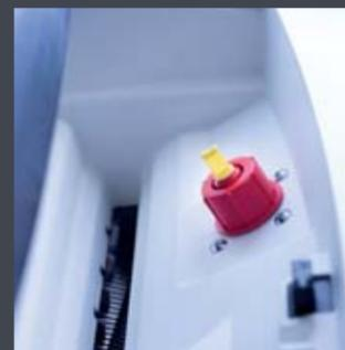
Der automatische Öler sorgt bei der Partikelschnitt-Version für gleichbleibende Schnittleistung und -qualität.
